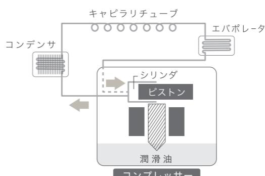
1. コンプレッサー（圧縮機）により高温高圧に圧縮した冷媒（作動流体）がコンデンサ（凝縮器）で放熱、液化します。
