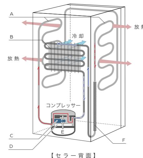
コンプレッサー [ 左図C,D,Eで構成 ] で低温低圧の気体の冷媒を圧縮します。このとき、冷媒は高温高圧の気体になります。高温高圧になった冷媒をコンデンサ [ 左図A ] ( 放熱器・凝縮器 ) に通すことで、庫外の空気中に放熱\*して常温高圧の液体にします。コンデンサの多くはセラーの側面や背面に取り付けられています。
