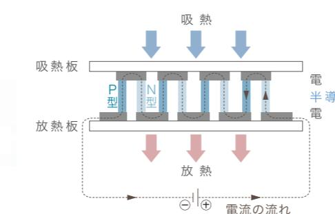
上図はペルチエ素子の断面図です。N型とP型の2種類の半導体素子があります（N型半導体は電子がつねに1個余分にあり、反対にP型半導体はつねに電子が1個不足しています）。2つの金属板（吸熱板と放熱板）に挟まれた2つの半導体は一体の素子として電子回路に接続されています。
